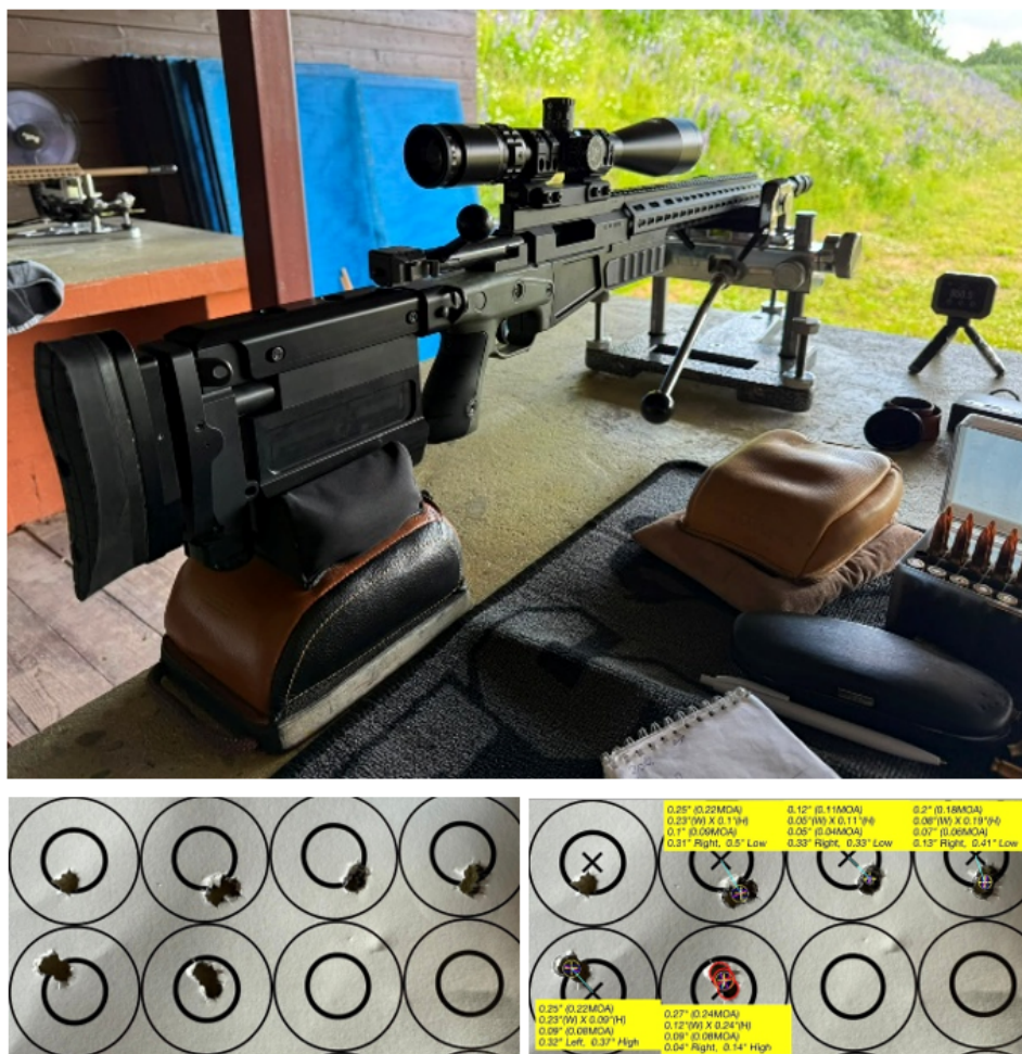
Рисунок 4. а-винтовка Ассигасу АХ на стрелковом столе; б, в, – 5 контрольных групп по 3 выстрела после настройки винтовки
